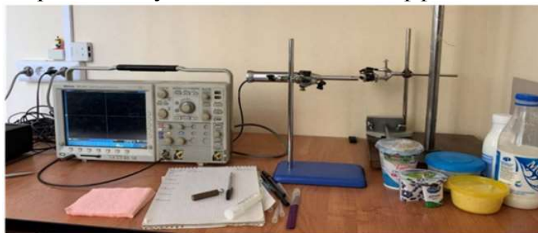
Рис. 1. Экспериментальная установка по определению коэффициента вязкости биологических тканей и жидкостей методом камертона
