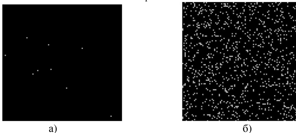
Рис.2 Эволюция процесса окисления: а) 1 эпоха, б) 100 эпоха. Размер исследуемой поверхности 100x100 клеток
