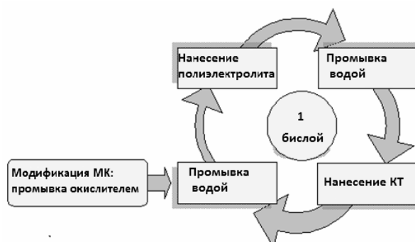
Рис. 1. Схема послойного нанесения полиэлектролита и раствора КТ
