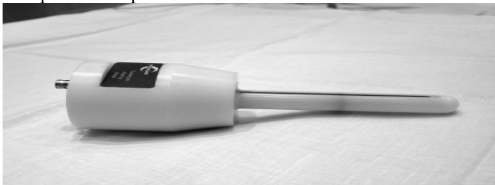
Рис. 2. СВЧ электрод на основе спиральной ЗС.
