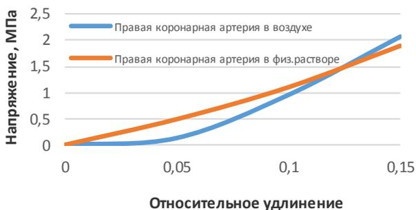
Рис. 1. Зависимость относительных удлинений от напряжений для правой коронарной артерии в различных средах
